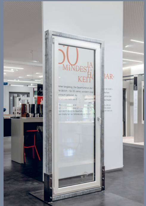
Duurfunctietest van een Finstral-aluminium-kunststof-kozijn deur 90 x 230 cm, uitgevoerd bij het Institut für Fenstertechnik (ift) Rosenheim met 65.000 cycli conform de norm voor het testen van de mechanische duurzaamheid EN 12400:2002-10; dit is een drie keer zo strenge eis als die van de RAL-kwaliteitsorganisatie.
