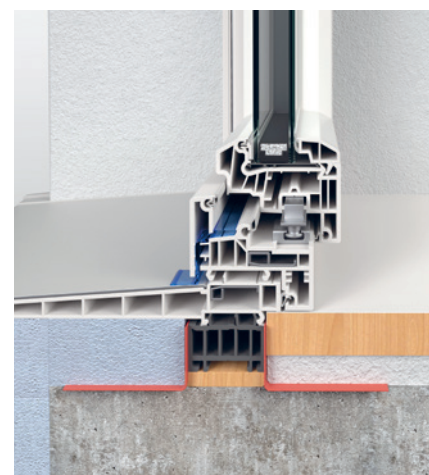
Sección transversal de un sistema Finstral con junta central
