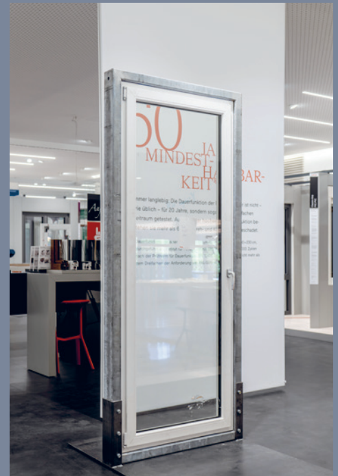
Test de durabilidad mecánica de una puerta balconera de Aluminio-PVC Finstral de 90 x 230 cm, realizado en el Institut für Fenstertechnik (ift) de Rosenheim con 65.000 ciclos de aperturas y cierres repetidos de acuerdo con la norma EN12400 para probar la durabilidad mecánica; de equivale a más del triple de lo exigido por las directrices de calidad RAL.
