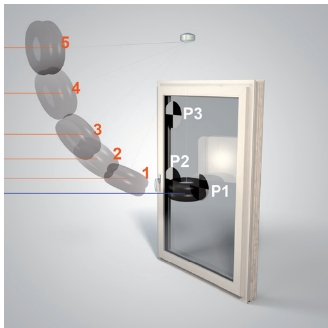
Puntos de impacto: P1 Punto central del vidrio/panel P2 Punto central del lado más largo del vidrio/panel P3 Ángulo del vidrio/panel
