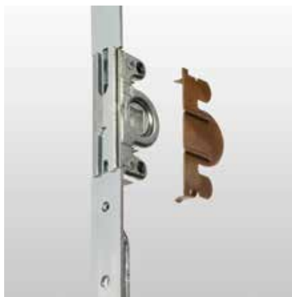
Le ferrage de sécurité avec rouleaux champignon, la plaque anti-perforation et la poignée verrouillable augmentent la protection anti-effraction des fenêtres Finstral.
