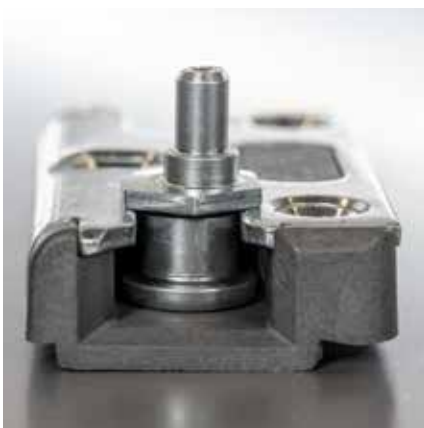
Le ferrage de sécurité avec rouleaux champignon, la plaque anti-perforation et la poignée verrouillable augmentent la protection anti-effraction des fenêtres Finstral.
