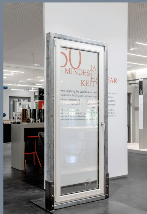
Test di durabilità di una porta-finestra Finstral in alluminio-PVC 90 x 230 cm, eseguito presso l'Institut für Fenstertechnik (ift) di Rosenheim con 65.000 cicli secondo la norma di prova EN 12400 che valuta la durabilità meccanica di porte e finestre a fronte di aperture e chiusure ripetute; ciò corrisponde a più di tre volte il requisito richiesto dal marchio di qualità RAL.
