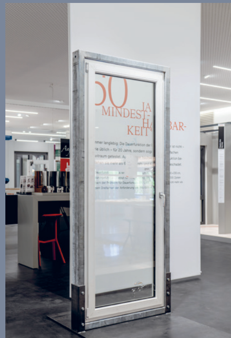
Ensaio de funcionamento contínuo de uma porta de sacada Finstral em alumínio-PVC, 90 x 230 cm, realizado no instituto alemão de janelas de Rosenheim (ift), com 65.000 ciclos, de acordo com a norma de ensaio para a durabilidade do funcionamento EN 12400:2002-10; isto corresponde a mais de três vezes o requisito da associação de certificação de qualidade RAL.
