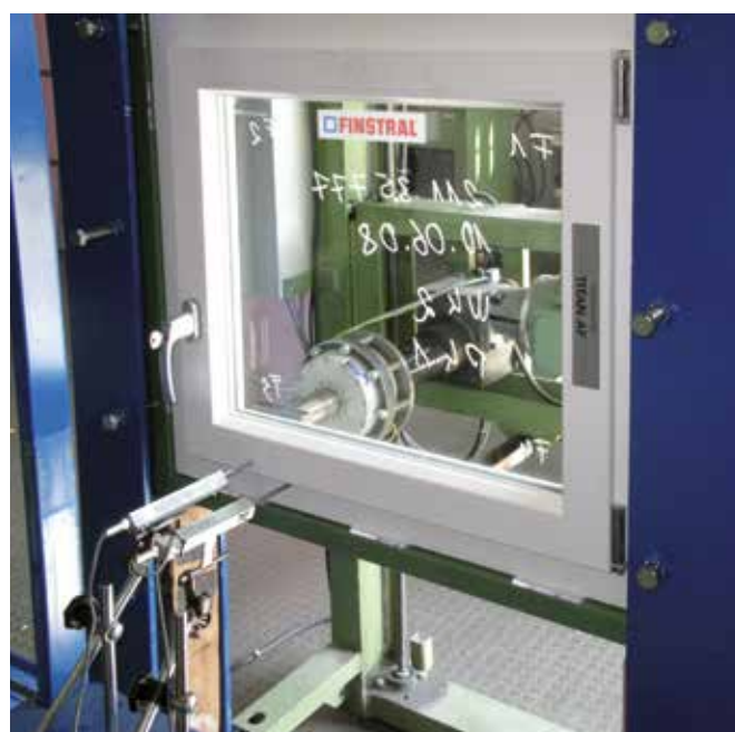
O ift realiza regularmente ensaios de segurança aos elementos de janelas Finstral.
