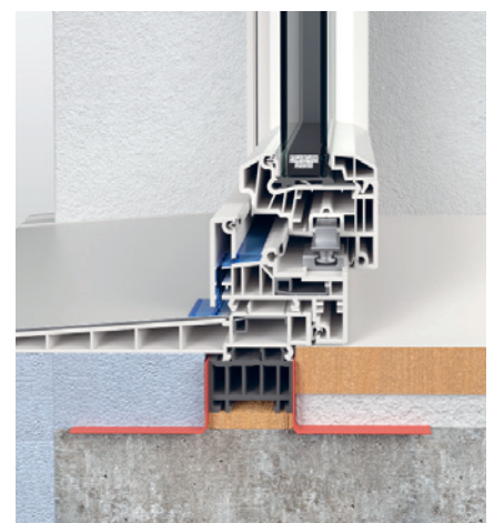
Schnitt durch ein typisches Mitteldichtungssystem von Finstral
