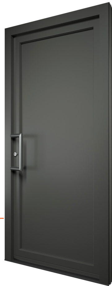
Haustür FIN-Door in einflügeliger Ausführung Modell 01 glatt, außen und innen Aluminium Anthrazitgrau F716, außen Stoßgriff 479 (600 mm) in Edelstahl, innen Griff 536 in Edelstahl, verdeckt liegende Bänder
