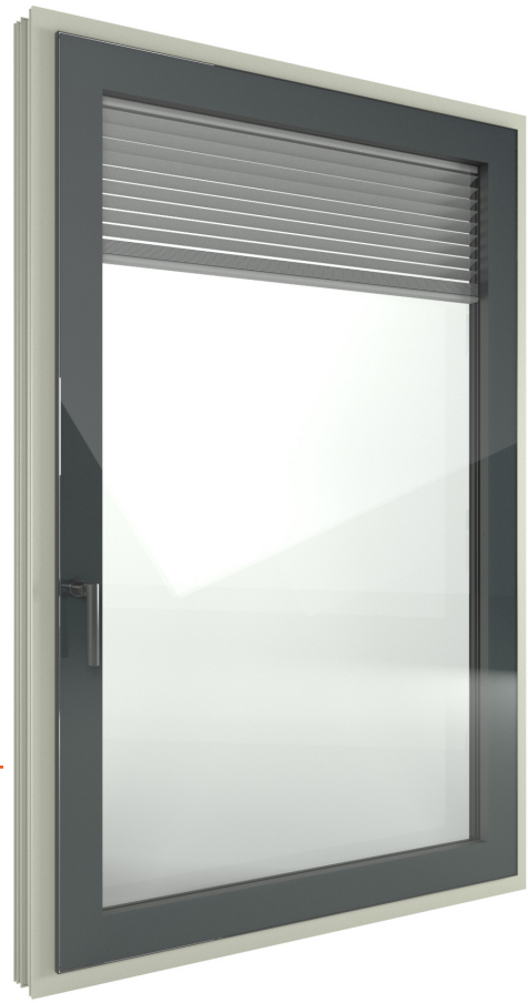
Abbildung in einflügliger Ausführung, außen Aluminium Sablé 894 Dunkelgrau und innen Kunststoff Seidengrau 46, Randemaillierungsfarbe Anthrazitgrau G04
