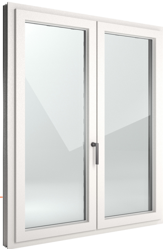
Abbildung in zweiflügliger Ausführung mit glasüberdecktem Stulp-Profil Nova, außen Aluminium Classic 303 und innen Kunststoff Weiß satiniert 45, Randemaillierungsfarbe Tiefschwarz G01
