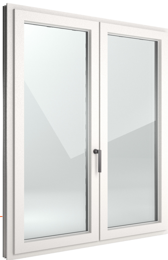
Abbildung in zweiflügliger Ausführung mit glasüberdecktem Stulp-Profil Nova, außen Aluminium Classic 303 und innen Kunststoff Weiß satiniert 45, Randemaillierungsfarbe Tiefschwarz G01
