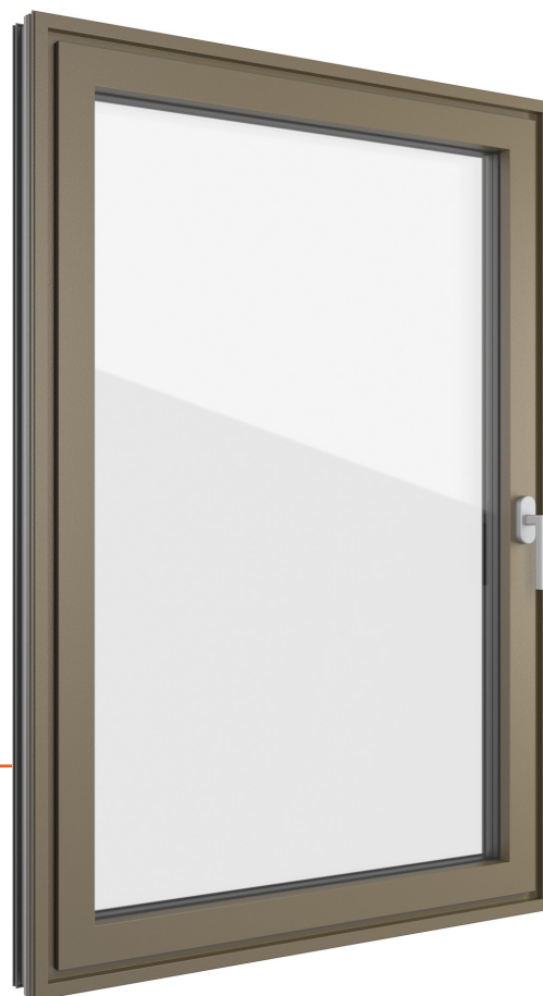
Abbildung in einflügliger Ausführung mit raumseitig flächenbündigem Blendrahmen und Flügel, außen Aluminium Sablé 583 Anthrazit und innen ForRes Terrabraun 95
