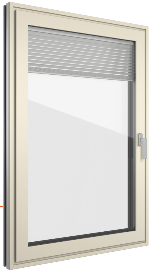
Abbildung in einflügliger Ausführung mit raumseitig flächenbündigem Blendrahmen und Flügel, außen Aluminium Classic 203 und innen ForRes Grauweiß 90
