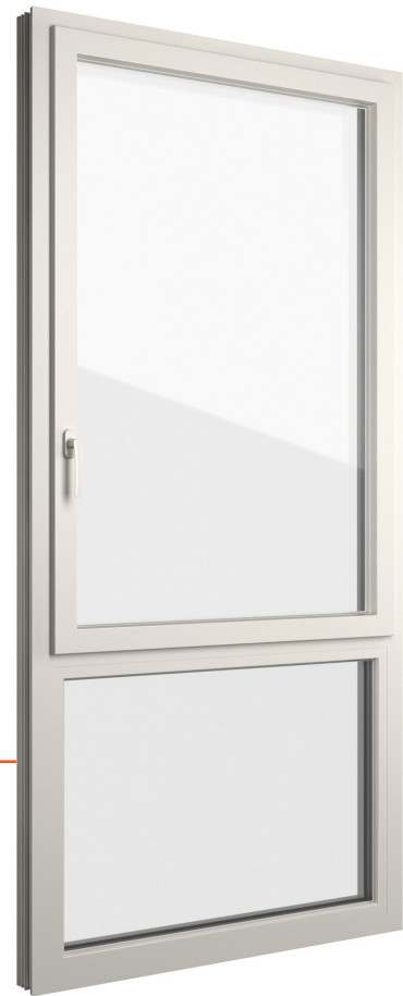
En la imagen: ejecución de una hoja con fijo inferior, exterior aluminio color Classic 203 e interior PVC blanco satinado 45
