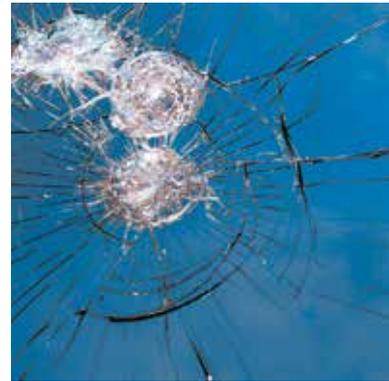
Si necesita una seguridad aún mayor, puede elegir nuestro vidrio laminado Multiprotect, compuesto por dos láminas de vidrio adheridas mediante una película altamente resistente a la rotura. En caso de rotura, la película une los fragmentos de vidrio, previniendo posibles lesiones. Además, Multiprotect también tiene una función de aislamiento acústico.
