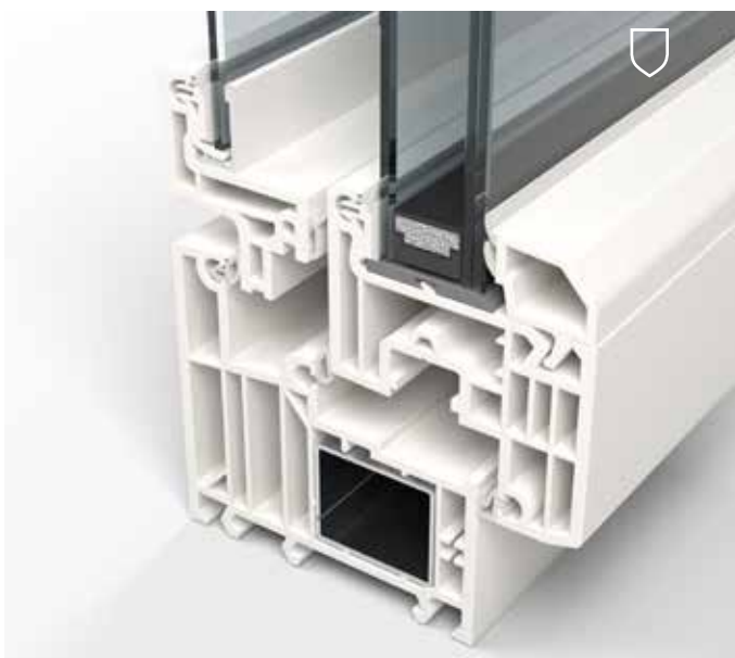
Schnitt durch ein Verbundflügel-Fenster mit drei Scheiben, innere Scheibe Verbundsicherheitsglas Multiprotect, Aufbau 33.1v-20-4T/6F0
