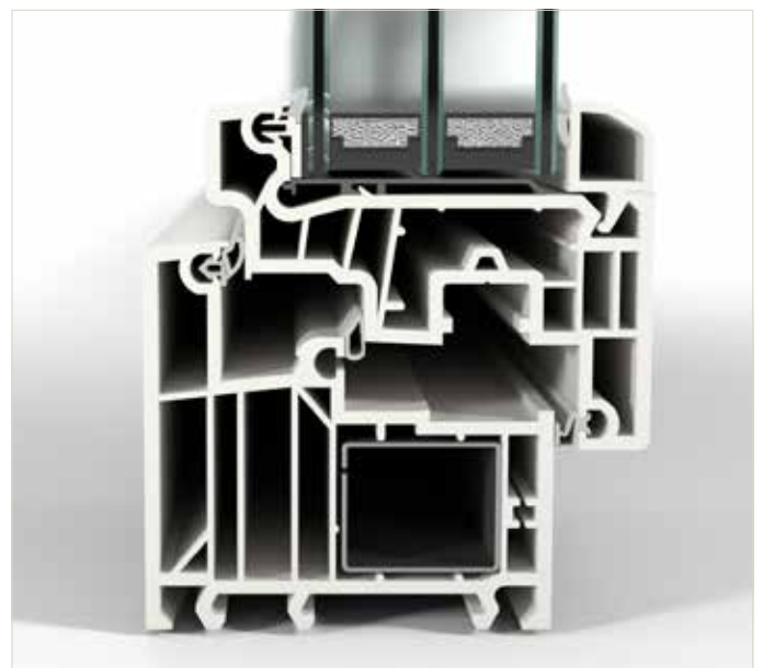
Schnitt durch einen Finstral-Kunststoff-Rahmen: FIN-Window Slim-line 77 Kunststoff-Kunststoff
