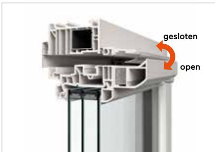
PassiveVent Midi: vleugelkadervariant met vochtigheidsregeling
