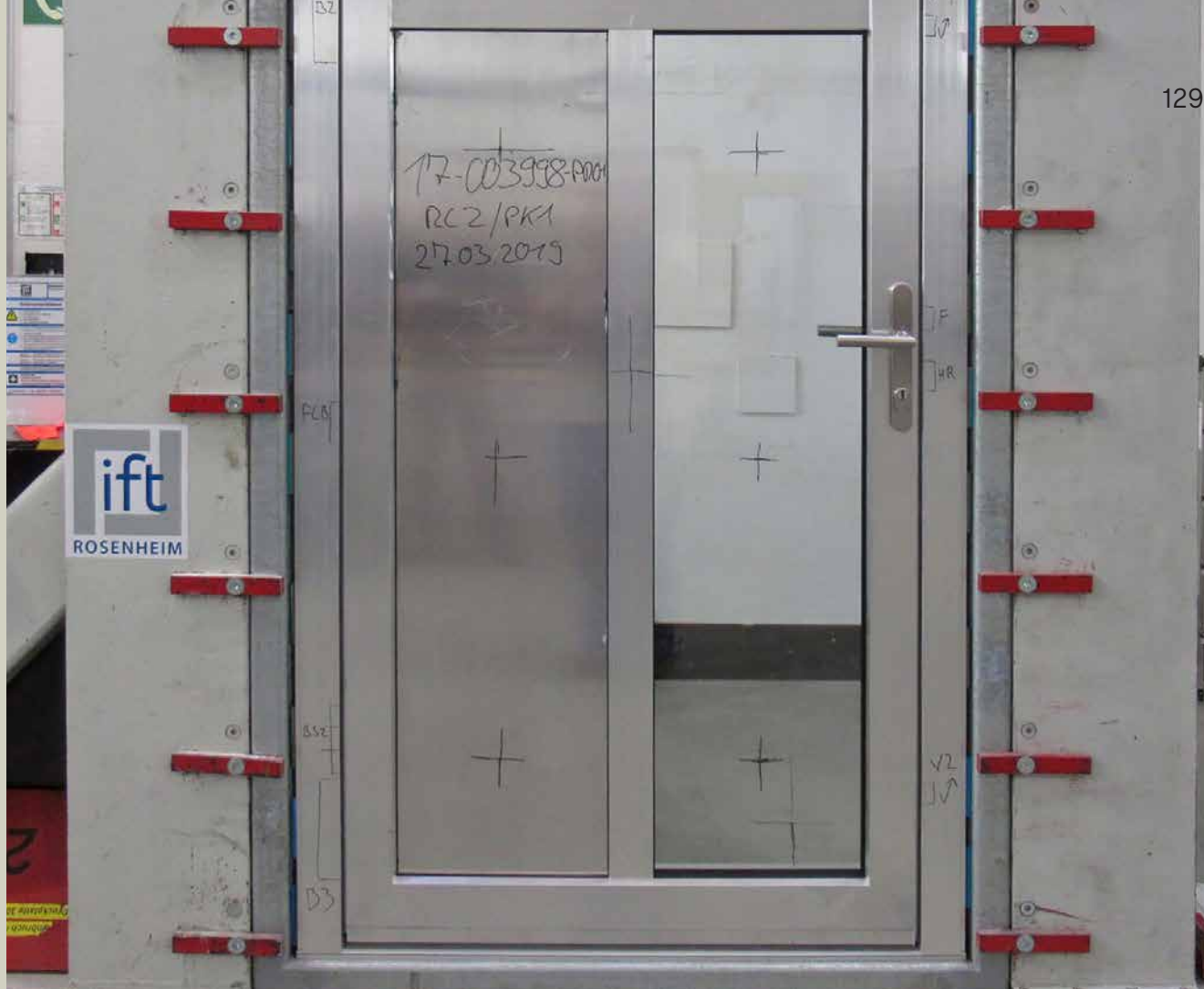
Am Prüfstand untersucht das Institut für Fenstertechnik (ift) Rosenheim die Einbruchsicherheit von Haustüren.
