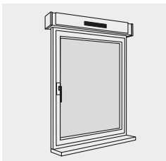
Einbau über dem Fenster
