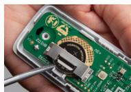
**3.** Setzen Sie eine neue Batterie (Typ CR 2032 3V) so in die Halterung ein, dass die Seite mit dem Pluszeichen sichtbar ist. Beachten Sie die Polarität. Die Anschlüsse dürfen nicht kurzgeschlossen werden. Drücken Sie die Batterie in das Fach.
