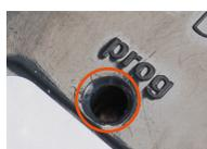
2. Falls Sie eine 5-Kanal-Fernbedienung löschen möchten, wählen Sie zunächst den gewünschten Kanal über den Kanalwahlschalter aus. Drücken Sie auf der Fernbedienung, die gelöscht werden soll, für ca. 2 Sekunden die Programmiertaste (prog). Die Fernbedienung ist gelöscht.
