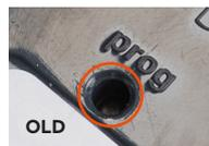
2. Falls Sie eine 5-Kanal-Fernbedienung hinzufügen möchten, wählen Sie zunächst den gewünschten Kanal über den Kanalwahlschalter aus. Drücken Sie auf der Fernbedienung, die hinzugefügt werden soll, für ca. 2 Sekunden die Programmiertaste (prog). Die Fernbedienung ist hinzugefügt.
